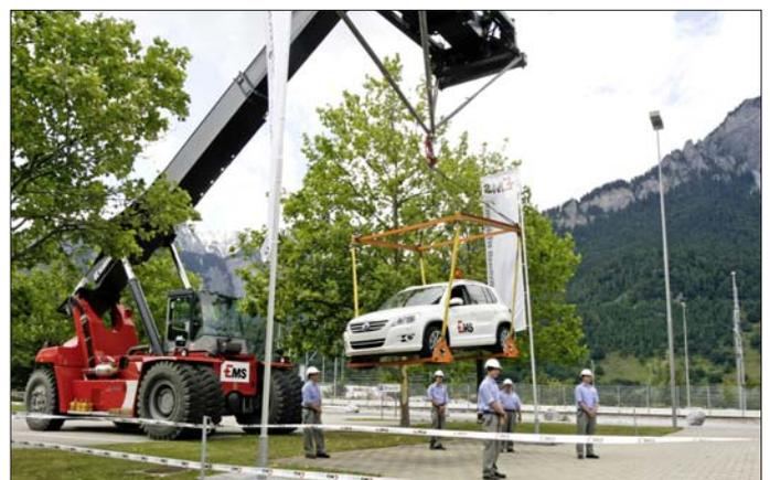
Bild 4b: Eindruckvolle Vorführung der Kraft der langen Fasern – ein Pw wird am Gewindetubus aufgehängt.
