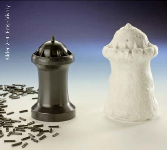
Bild 2: Bauteil vor und nach Veranschung.
